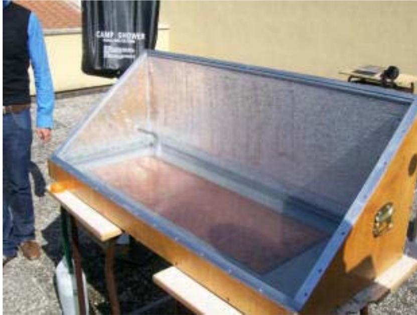
*Figura 2: Foto dell'evaporatore solare.*
